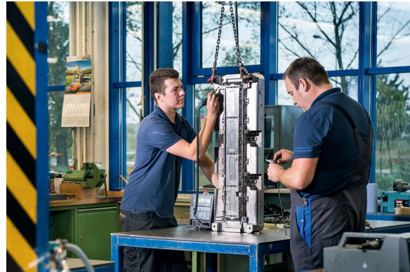
Montage eines Spritzgusswerkzeuges
